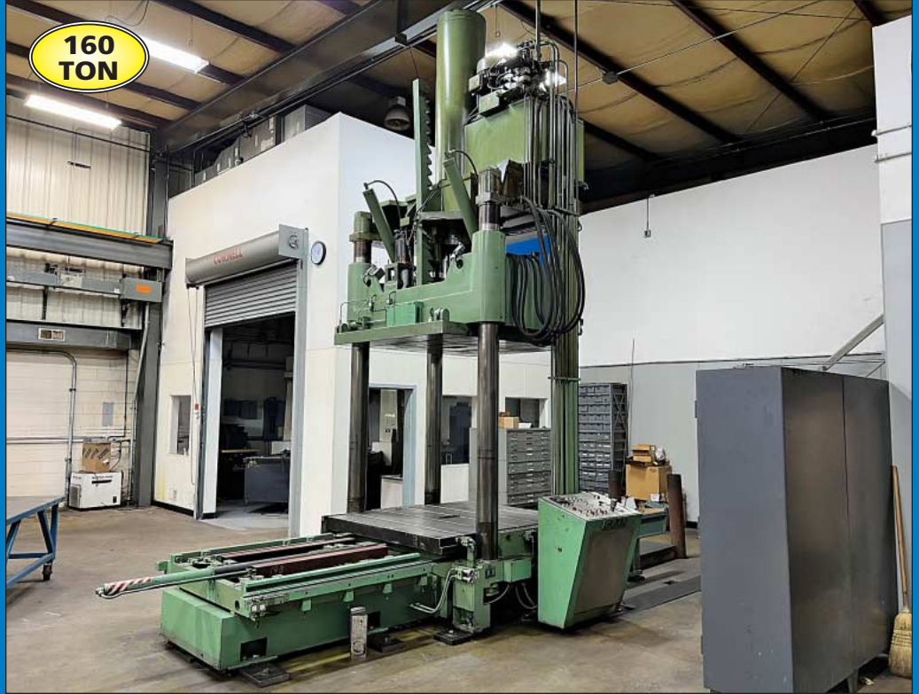
160 Ton Reis Model TUS160 OK Hydraulic Die Spotting Press
