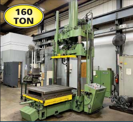
110 Ton Reis Model TUS125 OK Hydraulic Die Spotting Press
